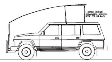
ANTENNA MOUNTED AT BUMPER BAR HEIGHT
